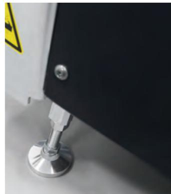
ポンプを始動すると電動ジャッキが自動的に作動し、機械を安定させます。
